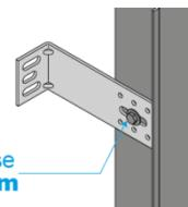
La fixation du profilé métallique sur l'équerre est faite avec l'utilisation d'une visautoforeuse Ø6,3mm.
